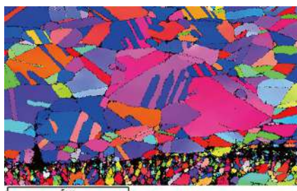
硬貨断面の EBSD 分析, GeminiSEM 460 20 kV, 5 nA, 20 分で 185,000 ポイント取得
